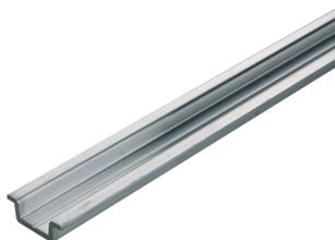
Carril de montaje DIN 15 con 15x5x1,5 mm, de aleación de aluminio, con sección de cobre de 16 mm<sup>2</sup> según EN 60715 TH 15, longitud de 2 m
