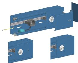
Canal d'allège 4670 200x115 mm. Avec rail d'ancrage stable C30 pour fixation avec coulisseau. - En tôle d'acier galvanisée. Ouvertures à l'avant.
