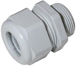
Kabelverschraubung M25x1.5 Klemm bereich Ø 9-16mm aus Polyamid
