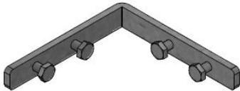
en tôle d'acier Dimensions : 67.5/67.5x10x2.5mm avec 4 vis à tête hexagonale M4x8 pour relier les coques du canal
