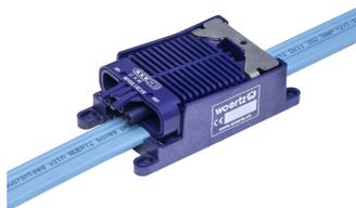
Caja de conexión rápida IP20/IP40, con toma de 3 polos, código 1, ocupación L-N-PE, 250V, 20A, para cable plano art. 48280.
