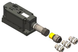
Caja de conexiones con adaptador de enchufe IP65 para cable plano POWER IP 5G10mm<sup>2</sup>, con 3 prensaestopas M20x1,5, Ø6,0-15,0 mm
