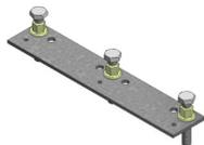
de chapa de acero galvanizado sendzimir Dimensiones: 360x50x4mm Con 3 tornillos hexagonales de nivelación M10x60 de poliamida y remaches ciegos para la fijación a la carcasa de la canaleta para el montaje adicional en caso de falta de apoyo.
