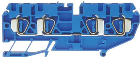
Zugfederklemme DIN35 2.5mm<sup>2</sup> 88x5x31mm blau mit 4 Anschlüssen Bezeichnungsmöglichkeit seitlich und in der Mitte mit Streifen, für Querverbindung versenkt
