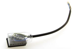
Boîte de jonction 5 pôles pour alimentation ou dérivation pour câble plat Technofil avec 0,3 m de câble rond HF 5x1,5 mm 2
