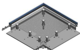
con nivelación integrada de chapa de acero galvanizado sendzimir de 1,5 mm prensada en perfil especial de aluminio Woertz en ambos lados con borde de protección temporal insertado en la ranura y goma trapezoidal resistente a los impactos como soporte de la cubierta Pernos hexagonales de nivelación M10x60 de poliamida incluido el material de conexión Altura 60mm / ancho nominal de la cubierta 400mm
