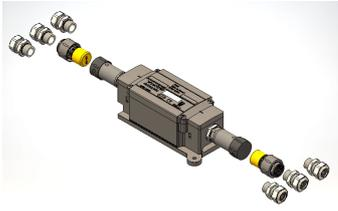
Abzweigdose mit zwei Sicherheitsadapter IP65 für Flachkabel 5G16mm<sup>2</sup>/5G25mm<sup>2</sup> mit 3 Kabelverschraubungen M20x1.5 Ø6.0-15.0mm.
