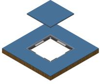
Tôle de suspension pour découpe 255x255mm en acier galvanisé sendzimir 1mm, avec cadre 250x250x12mm en aluminium 2mm, avec caoutchouc d'appui du couvercle 3mm. Couvercle borgne 245x245x4mm en acier galvanisé sendzimir 4mm, à garnir 3mm
