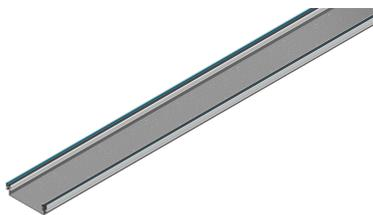
en tôle d'acier galvanisée sendzimir 1.5mm pressée des deux côtés dans un profilé spécial en aluminium Woertz avec bord de protection provisoire inséré dans une rainure et caoutchouc trapézoïdal contre les bruits d'impact comme support de couvercle, y compris pattes de fixation et matériel d'assemblage Hauteur 50mm / largeur nominale du couvercle 200mm
