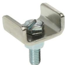
para 2 conductores hasta 16mm<sup>2</sup>, abrazadera de cobre con tornillo de acero, arandela elástica y tuerca M5
