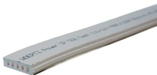
Flachkabel Woertz Ecobus Power IP 5x2.5mm<sup>2</sup>, 3LNPE, halogenfrei, Leiter Litze Kupfer blank, mit einem gemeinsamen Kern für alle Adern, Schutzleiter auf dem Kern gelb/grün markiert, Nennspannung 0.6/1 kV, Prüfspannung 4 kV, neue Profilerung mit glatter Oberfläche für IP68 Flachkabel Dosen, kompatibles Befestigungsmaterial, neue Endstücke, VDE zugelassen, Mantel Copolymer, thermoplastisch, FR/LS0H, Brandverhaltensklasse B2ca s1 d0 a1, lichtgrau, Leiter weiss ausser PE.
