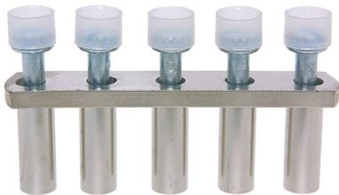
Isolierte Querverbindung 5-polig zu Reihenklemmen DIN32/35 16mm<sup>2</sup> inklusive Schrauben M4. Abmessung: 53x29.8 mm
