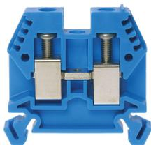
Bloc de jonction DIN35 10mm<sup>2</sup> 45x8x42mm bleu avec le meilleur contact possible, vis en acier inoxydable, possibilité de repérage à 4 chiffres des deux côtés, encastré pour les connexions transversales
