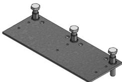
en tôle d'acier galvanisée sendzimir 4mm Dimensions : 260x100mm avec 3 vis à six pans creux de mise à niveau M10x60 polyamide avec rivets aveugles pour la fixation à la coque du canal pour un montage supplémentaire en cas d'absence de raccord.
