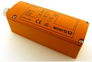
Brandsicherheitsdose IP66/IP68, 2-Schrauben-Kontaktierung zur abisolierfreien Einspeisung und Abzweigung, mit Schraubanschluss für Starkstrom 5G4 mm<sup>2</sup>, längs abgehend, inkl. 3 x Kabelverschraubungen M20x1.5, mit einem Klemmbereich von jeweils Ø 6-8 mm, Ø 8-11 mm und Ø 11-15 mm.
