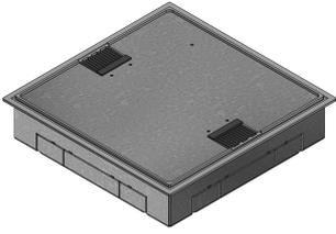
Anschlusskasten BAK4 284x284/30 mit Rahmen aus Aluminium und Deckel aus Stahlblech 4mm
