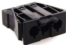
Attacco apparecchio per sistema di prese Woertz, spina, nero, codice 1, a 3 poli, bloccabile. Spessore minimo della parete: 0,5 mm, spessore massimo della parete: 1,2 mm. Adatto per il collegamento alla rete elettrica monofase in combinazione con l'installazione del cavo piatto Woertz.
