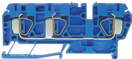
Terminale a morsetto DIN35 4mm<sup>2</sup> 88,5x6x35mm blu con 2 connessioni Possibilità di marcatura sul lato e al centro con strisce, incassato per la connessione trasversale
