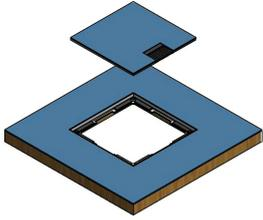
Tôle de suspension pour découpe 205x205mm en acier galvanisé sendzimir 1mm, avec cadre 200x200x12mm en aluminium 2mm, avec caoutchouc d'appui du couvercle 3mm. Couvercle 195x195x4mm en acier zingué sendzimir 4mm, à garnir 3mm, avec baguette à brosse noire 54x30mm.
