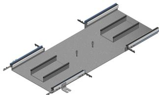
en tôle d'acier galvanisée senzimir 1.5mm longueur=1000mm avec arête de protection provisoire pour couvercle de largeur 400mm avec pattes de fixation et matériel de jonction
