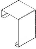
Versión izquierda, abierta lateralmente de chapa de acero galvanizada de 1,5 mm
