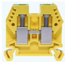
Reihenklemmen mit bestmöglicher Kontaktierung. Abmessung: 45x8x42mm. Schrauben aus rostfreiem Stahl, beidseitig 4-stellige Bezeichnungsmöglichkeit, für Querverbindungen versenkt.
