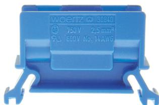
Borne de derivación sin pieza de empuje, tornillos prisioneros con ranura, piezas metálicas de latón niquelado, deslizador antidesplazamiento para conductores pasantes, opción de marcado de 4 dígitos
