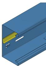
in lamiera d'acciaio zincata da 1 mm con guida DIN35
