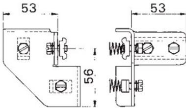
de chapa de acero de 3 mm, galvanizada con tornillos de ranura hexagonal de acero galvanizado M16x16, arandelas elásticas y tuercas de ranura para insertar en el carril de perfil nº 4283, tipo C30 con 4 tornillos y 2 placas de anclaje de 50 mm de longitud
