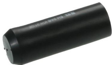
Pieza final del cable retráctil - tapa final, diámetro 42 mm, después de la contracción 15 mm, longitud 105 mm, negro. Interior recubierto con adhesivo y compuesto de sellado.
