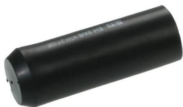
Embout de câble rétractable - embout, diamètre 42 mm, après rétraction 15 mm, longueur 105 mm, noir. Intérieur revêtu de colle et de mastic.
