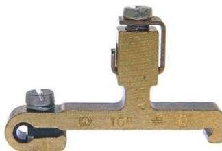
Schutzleiterklemme DIN35 16mm<sup>2</sup> 50x8x36mm blank Schrauben und Federn aus rostfreiem Stahl
