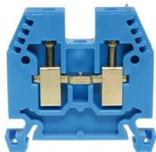
Bloc de jonction DIN35 6mm<sup>2</sup> 45x7x42mm bleu avec le meilleur contact possible, vis en acier inoxydable, possibilité de repérage à 4 chiffres des deux côtés, encastré pour les connexions transversales
