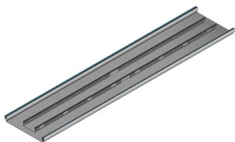
en tôle d'acier galvanisée sendzimir 1.5mm pressée des deux côtés dans un profilé spécial en aluminium Woertz avec bord de protection provisoire inséré dans une rainure et caoutchouc trapézoïdal contre les bruits d'impact comme support de couvercle, y compris pattes de fixation et matériel d'assemblage Hauteur 60mm / largeur nominale du couvercle 400mm
