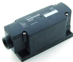
Boîte de dérivation 5x10mm<sup>2</sup> capacité de conducteur: 2.5 à 10mm<sup>2</sup> IP66/68 sans halogène et avec protection anti-corrosive. Contact avec vis piercing et connexion de câble rond par 1 filetage de presse-étoupe M25x1.5.
