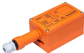
Caja de empalme E90 con adaptador de fusible IP66/68 para cable plano FE180 E90 5G16mm 2 con 3 prensaestopas M20x1,5 Ø6,0 - 15,0mm Versión específica para el proyecto a petición (ver documento/G00'299)
