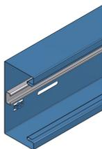
in lamiera d'acciaio zincata da 1 mm con guida di ancoraggio 29x15x2 mm, compresi materiale di collegamento e filo di terra
