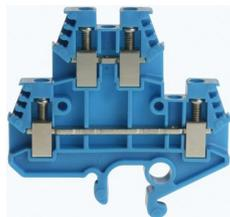
Abrazadera de cubierta doble DIN32 4mm<sup>2</sup> azul con tornillos de acero inoxidable, avellanados para conexiones transversales, opción de marcado de 2x3 dígitos en ambos lados
