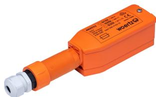
Brandsicherheitsdose mit Sicherungsadapter IP66/68 für Flachkabel FE180 E90 3G2.5 mm<sup>2</sup> inkl. 3 x Kabelverschraubung M20x1.5, mit einem Klemmbereich von jeweils Ø 6-8 mm, Ø 8-11 mm und Ø 11-15 mm
