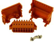
mit Federanschluss Farbe: orange Anschlussquerschnitt 0.08 - 1.5mm 2 Anschlussleistung max. 250V/10A
