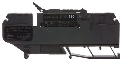
Zugfeder-Sicherungsklemme 4mm<sup>2</sup> schwarz für Spannung 85-264V AC/DC für Sicherung 5x20mm für G-Schmelzeinsatz, Isolierkörper Polyamid 6/6 schwarz für Querverbindung versenkt, mit Sicherungshalter
