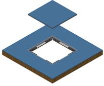
Tôle d'accrochage pour découpe 205x205 en tôle d'acier galvanisée sendzimir 1mm, avec cadre 200x200x12mm en aluminium 2mm, avec caoutchouc d'appui du couvercle 3mm. Couvercle aveugle 195x195x4mm en tôle d'acier galvanisée sendzimir, épaisseur 3mm
