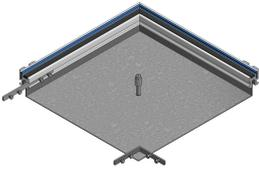
en tôle d'acier galvanisée senzimir 1.5mm avec arête de protection provisoire pour couvercle de largeur 300mm avec pattes de fixation et matériel de jonction
