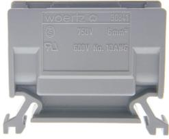
Abzweigklemme ohne Druckstück, Gewindestifte mit Schlitz, Metallteile Messing vernickelt, Spreizschuttschieber für Leiter durchgehend, 4-stellige Bezeichnungsmöglichkeit
