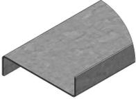
de chapa de acero galvanizado sendzimir 1mm longitud: 670mm
