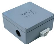
Zentraleinspeisedose für Flachkabel Woertz 5G25mm<sup>2</sup>/5G16mm<sup>2</sup>, IP65, Anschlussleitung. Ein drahtig, mehr drahtig und fein drahtig max. Querschnitt 35 mm<sup>2</sup>. Abisolierlänge 40 mm. Zu verwenden mit Kabelverschraubung M50x1.5, Art. 49642 (Ø25-31 mm) oder Art. 49644 (Ø32-38 mm).
