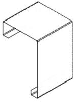
Eckstück Ausführung links für Klappdeckelkanal KDK 220x150, seitlich offen aus verzinktem Stahlblech 1.5mm
