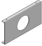
Steckdeckel Dräger Farbwahl MEK 4675 aus Aluminium-Profil 1.7mm mit Bohrung ø 42,5mm
