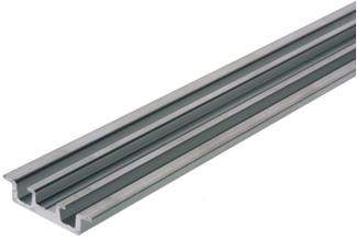
Kombischiene Extrudal-050 DIN35/DIN15, mit 35x7.5x3.3 mm, aus Alu-Legierung, mit einem 35 mm<sup>2</sup> Kupferquerschnitt, 2 m Länge
