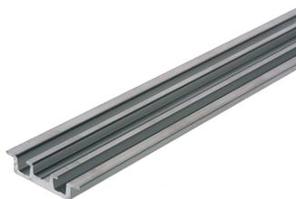
Rail combiné Extrudal-050 DIN35/DIN15, avec 35x7.5x3.3 mm, en alliage d'aluminium, avec une section de cuivre de 35 mm<sup>2</sup>, longueur 2 m
